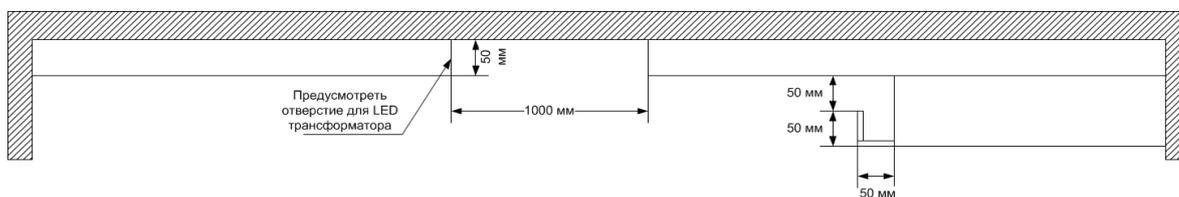
8. Перестенок лестницы: сборка каркаса, крепеж г/к листов, укладку утеплителя между г/к листами, установка м/п двери
