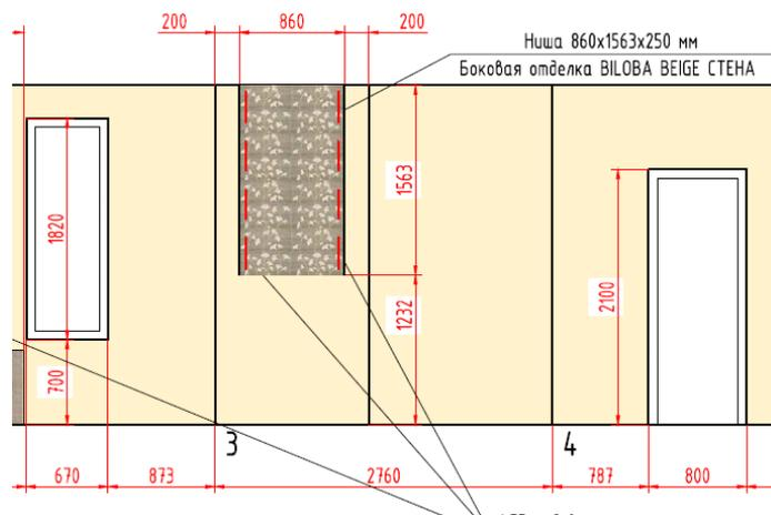
Глубина обшивки инсталляции: 250 мм
